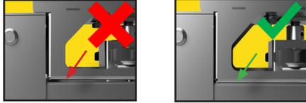
Es darf kein Spalt zwischen Steuereinheit (8) und Pump-Filtereinheit (11) vorhanden sein.
