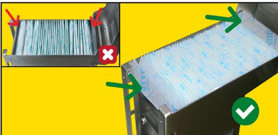
Lassen Sie die letzte Falte auf beiden Seiten der Pump-Filtereinheit (11) überlappen.
